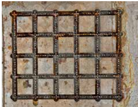
Perforačný systém dvadsaťbloku s rohovými výbehmi ihiel. Majetok Tiskárny Hradištko, s.r.o.
